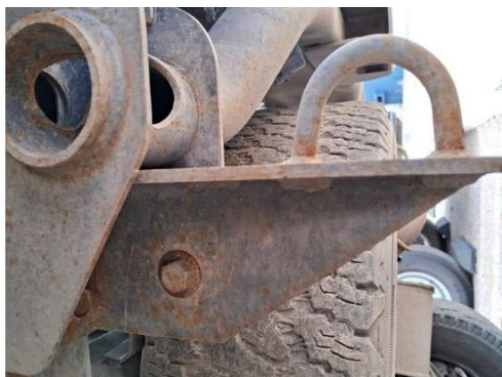
GANCHO DE ARRASTRE TRASERO ADICIONAL INSTALADO EN CHASIS (IMAGEN DE REFERENCIA)
