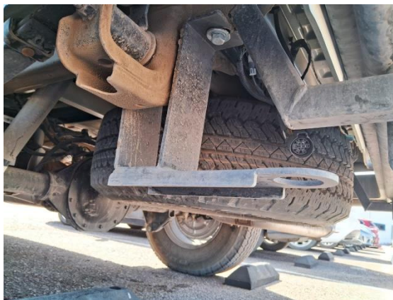
GANCHO DE ARRASTRE TRASERO ADICIONAL INSTALADO EN CHASIS (IMAGEN DE REFERENCIA)
