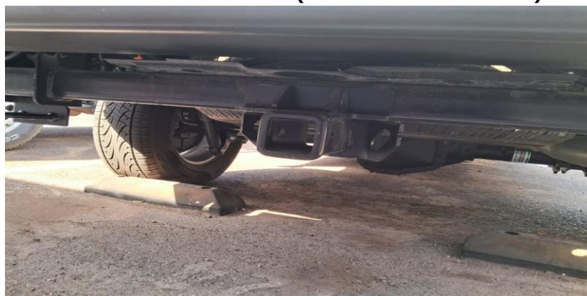
GANCHO DE ARRASTRE TRASERO ADICIONAL INSTALADO EN CHASIS (IMAGEN DE REFERENCIA)
