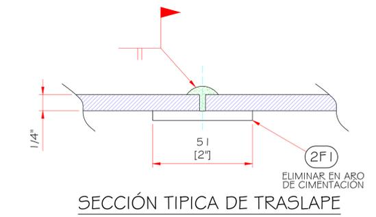
SECCIÓN TÍPICA DE TRASLAPE
